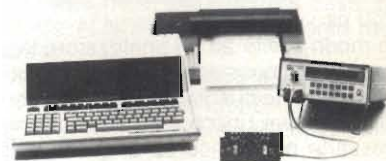
Frequenzimetri per sistemi portatili della HP, con un campo di frequenze che va da 10 Hz a 1 GHz.
