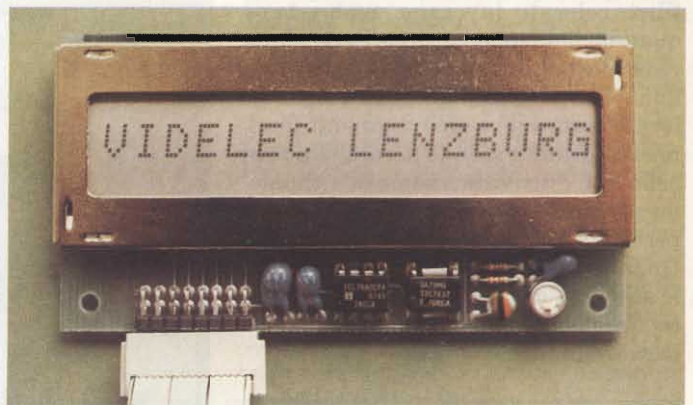
Fig. 8 - Modulo Videlec LC 943160 nel quale i caratteri alfanumerici (16) sono formati mediante matrici di punti (9 x 5).
