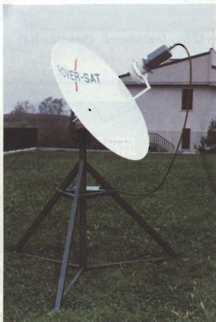
Fig. 9 - Antenna da 1 m diametro, completa di treppiede ed illuminatore utilizzata per ricezione segnali TV del Gorizont 4 in un sistema trasportabile. (Archivio Rover).
