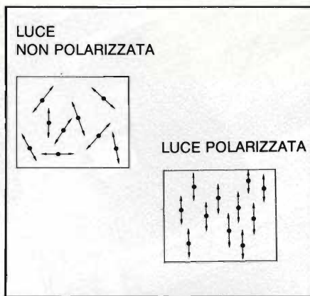
Fig. 4 - A sinistra: luce non polarizzata. La direzione di oscillazione delle singole oscillazioni è varia. A destra: luce polarizzata. Le direzioni di tutte le oscillazioni sono rigorosamente allineate secondo la direzione di propagazione della luce.
