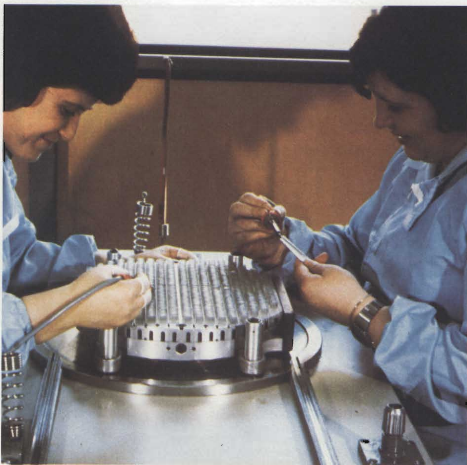
Una fase di lavorazione e di preparazione dei componenti di un display LCD alla Videlec - Philips.
